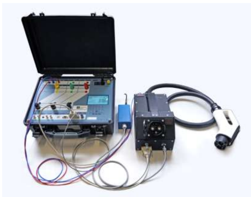
Рис. 9. Подключение ЭМТ-200/500 к Энергомонитору 3.1КМ-А (кл. т. 0,05)
