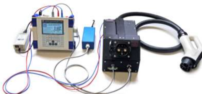
Рис. 10. Подключение ЭМТ-200/500 к Энергомонитору 3.1КМ-А (кл. т. 0,1)
