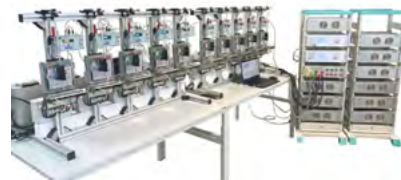
Пример установки с УНСЗ-10 для одновременной поверки 10 трехфазных счетчиков.
