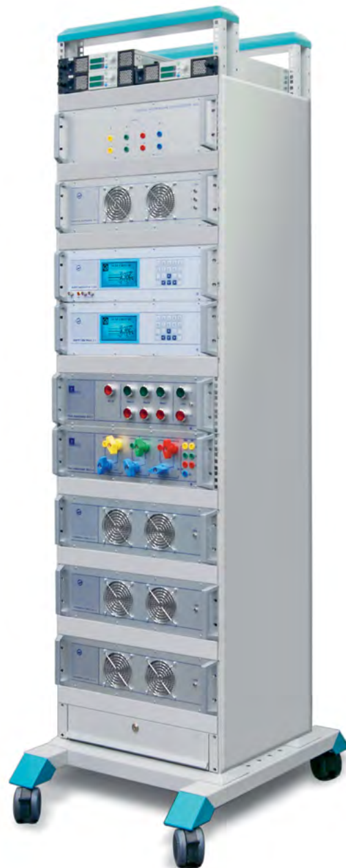
Пример установки с УНСЗ-10 для одновременной поверки 10 трехфазных счетчиков.
