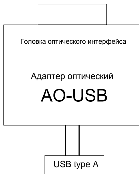
Рисунок 2.1 Функциональная схема Адаптера АО-USB.
