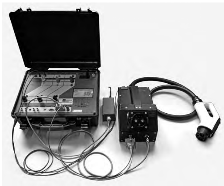
Рис. 9. Подключение ЭМТ-200/500 к Энергомонитору 3.1КМ-А (кл. т. 0,05)
