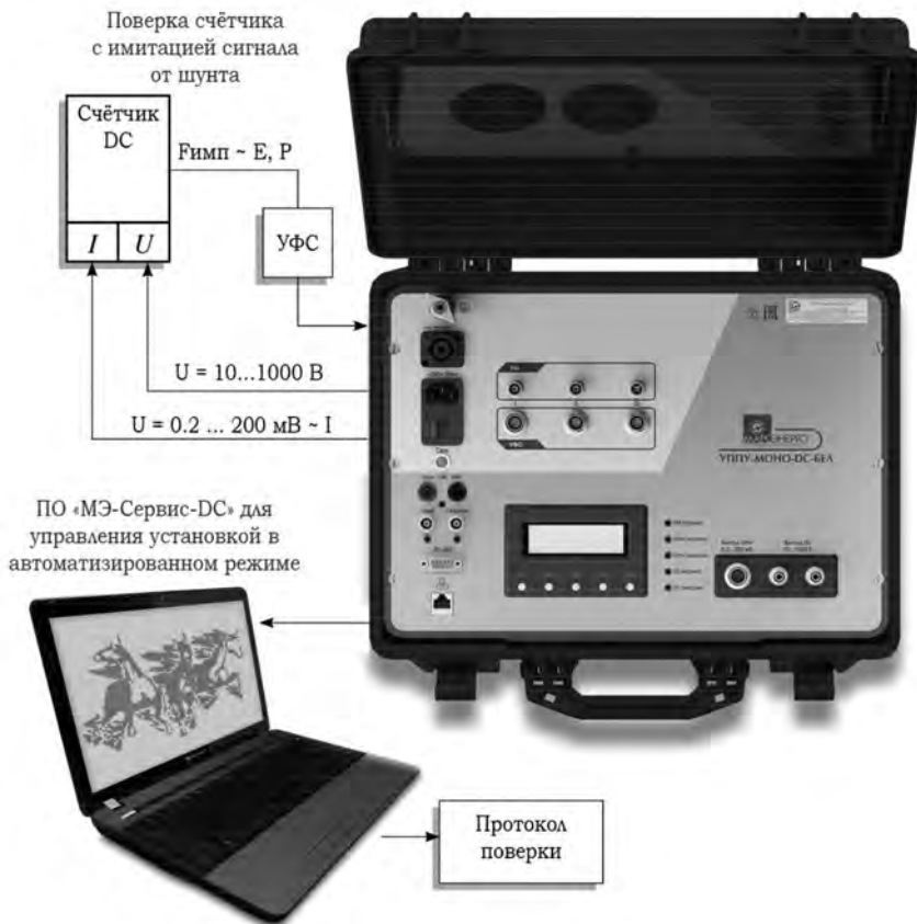
Рис. 13. Схема поверки счётчиков постоянного тока на установке УППУ-МОНО-DC с имитацией сигнала от шунта
