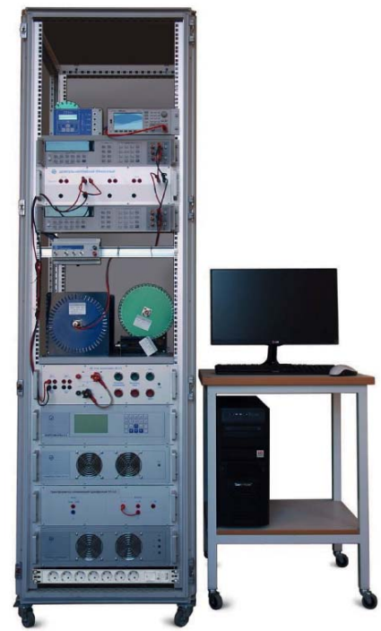
Рис. 1. Вторичный эталон мощности «ВЭТ-МЭ 1.0»
