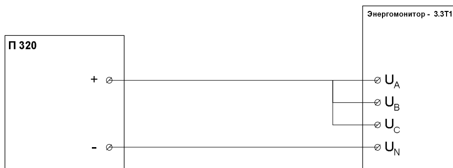
Рисунок А5 Схема подключения Энергомонитора-3.3Т1 к калибратору постоянного напряжения П320
