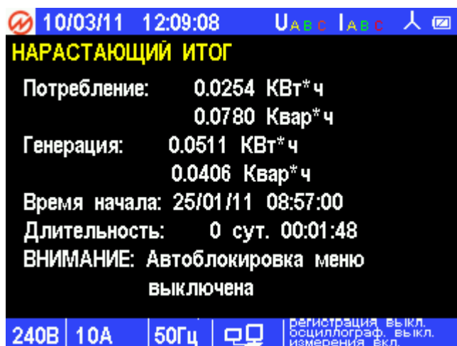
Рис. 1.4. Режим измерения энергии нарастающим итогом на экране прибора «Энерготестер ПКЭ»
