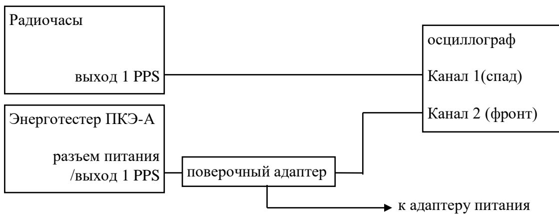
Рисунок А.4. Схема подключения Прибора для определения погрешности синхронизации при работе в режиме синхронизации с Международной шкалой координированного времени
