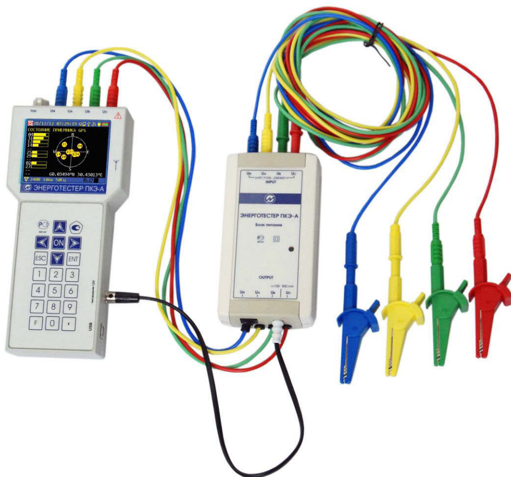
Рисунок Б1.1 - Схема подключения питания Энерготестера ПКЭ-А через блок питания универсальный
