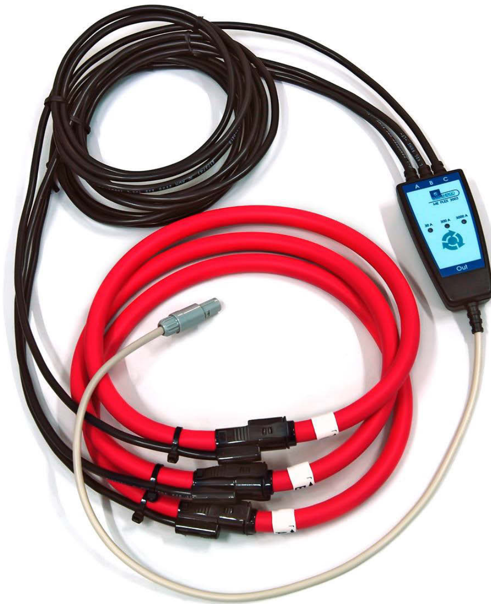
Рисунок А.9 - Комплект гибких токоизмерительных клещей 30 / 300 / 3000 А
