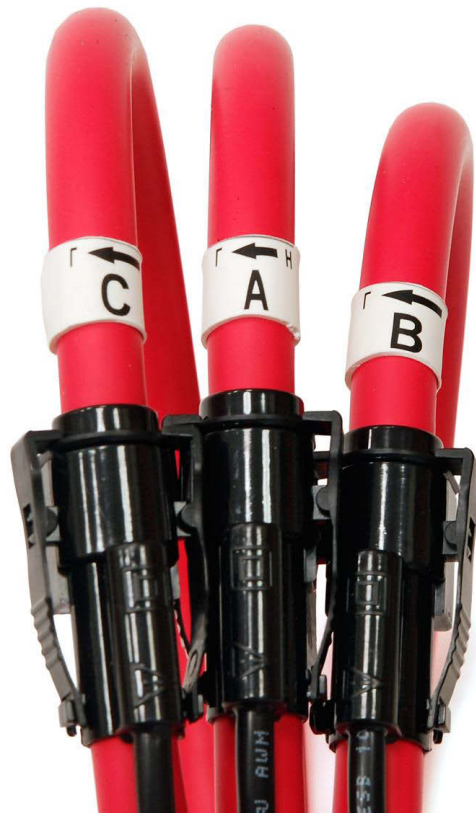
Рисунок А.11 - Расположение маркировки «генератор → нагрузка» на токоизмерительных клещах 30/300/3000 А
