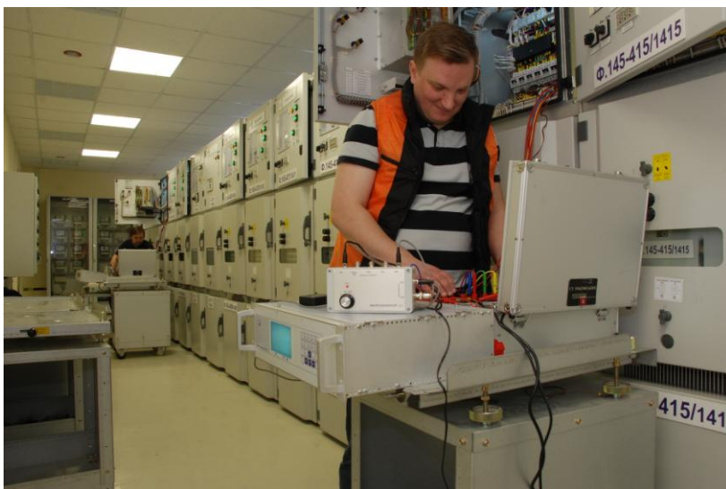
Рис. 2. Поверка счётчиков класса 0,2S
