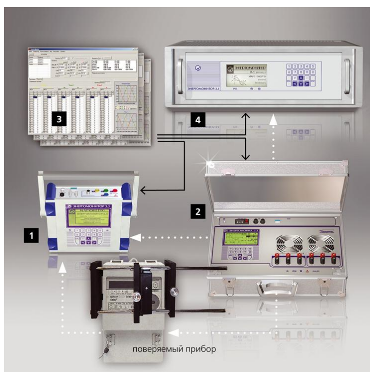
Рис.4. 1 – Энергомонитор 3.3Т1; 2- Энергоформа-3.3; 3 – ПО; 4 - Энергомонитор 3.1К.
