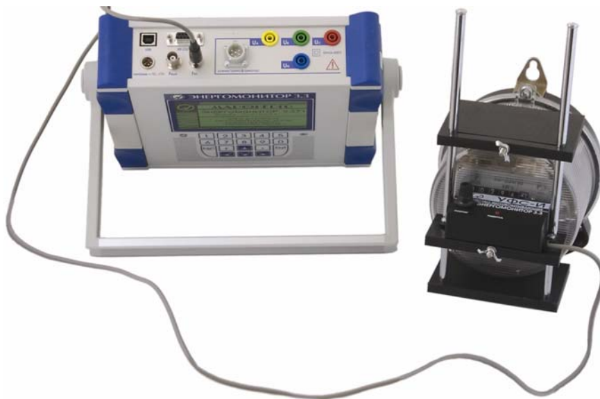
Рис. 1.1. Счетчик с УФС-И, подключенный к «ЭМ 3.3Т1»
