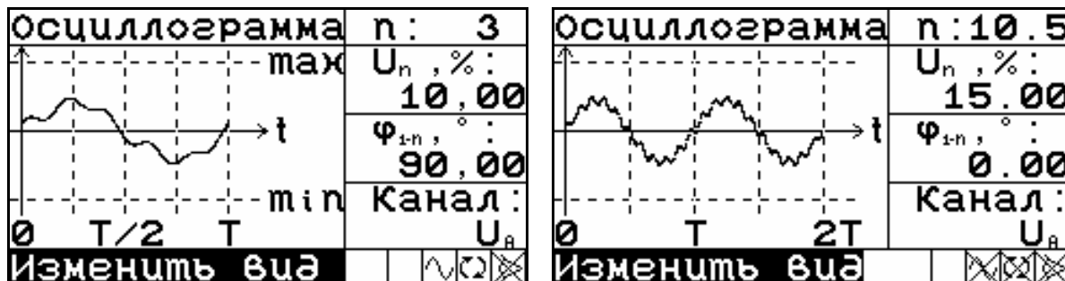
Рис. 4.10. Окно «Форма сигнала» в варианте представления «Осциллограмма» (слева — режим интергармоник выключен, справа — режим интергармоник включен)
