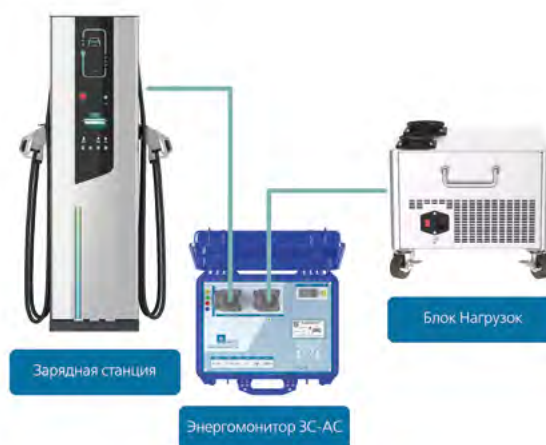
Рис. Поверка зарядной станции при работе на резистивную нагрузку
